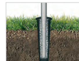
Granulat / Verguss Einstellen und Fixieren von Röhren mit Granulat oder Vergussmasse.
